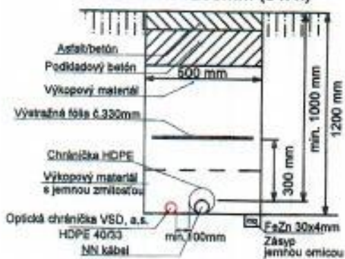
Káblový výkop- spevnená plocha, komunikácia 500mm x 1200mm (š x h)
